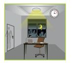
Nach einer Stand-by-Zeit dimmt der Sensor die Lampe auf einen niedrigen Lichtpegel, wenn keine neuen Bewegung registriert wird.
