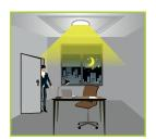
Mit unzureichendem Umgebungslicht schaltet der Sensor die Lampe an, sobald eine Bewegung erkannt wird.
