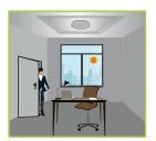
Bei ausreichendem Umgebungslicht schaltet der Sensor die Lampe nicht an.
